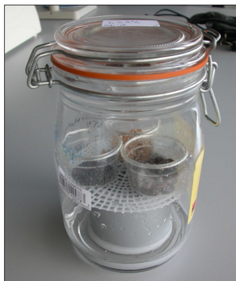
Acima: Jarra hermética com solução de cloreto de lítio, mostrando malha plástica para manter as sementes acima da solução.
