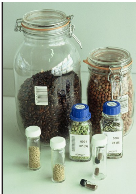
Acima: Cinco tipos de recipientes de vidro usados pelo MSB: jarras de 3000 cm 3 , 1000 cm 3 , garrafa quadrada de 100 cm 3 , garrafa universal de 30cm 3 e frasco de 2 cm 3 .
